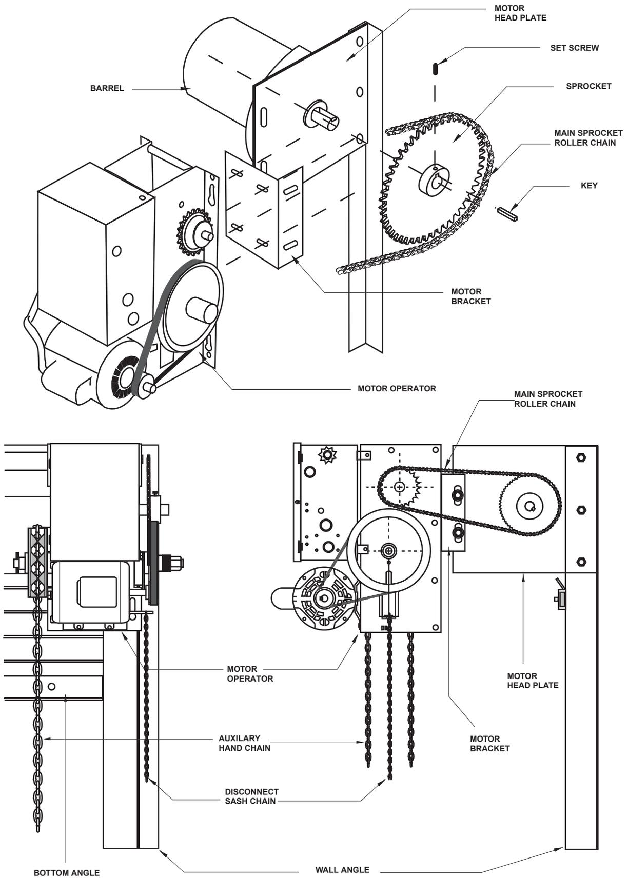
FIGURE 8 MOTOR OPERATOR SIDE
