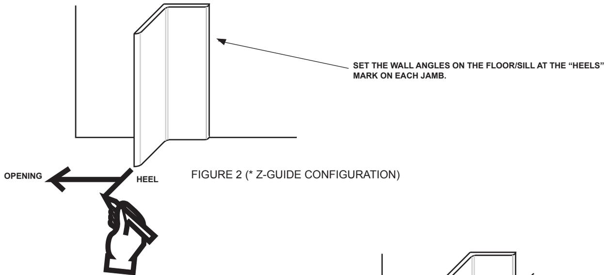
SET THE WALL ANGLES ON THE FLOOR/SILL AT THE "HEELS" MARK ON EACH JAMB.
