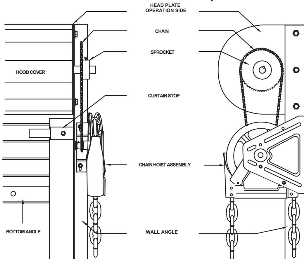
FIGURE 7 CHAIN OPERATOR SIDE
